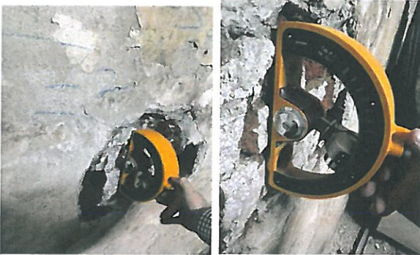
6)SCLEROMETRIE CARAMIDA CPP Z2 SUBSOL - ECHIV -C 80-90 Dr.ING.SPECIALIST NDT.PAVLU TEODOR
