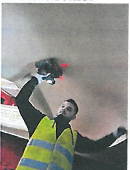
30) PAHOM /RADAR PLANSEU PL3 ET 1 SALA BALCON - BARE 8 MM / 15-20 CM CM - GROSIME PLACA 11 CM
