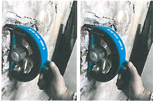
13) SCLEROMETRIE MORTAR Z1 SUBSOL - ECHIV - M15 = VAR
