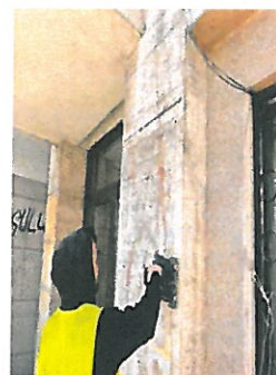
35) RADAR STALPI PARTER FATADA LATERALA 58 - BETON ARMAT /DIAFRAGMA /BARE VERTICALE LA 25 CM
