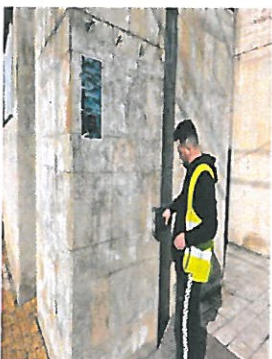
33) RADAR STALPI PARTER COLT 56 - BETON ARMAT /DIAFRAGMA /BARE VERTICALE LA 20 CM
