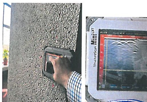
4) RADAR STALPI S4 - ETAI - BETON ARMAT
