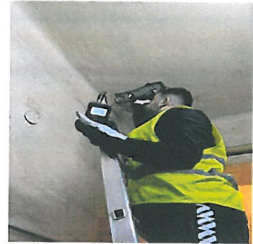
24 )BETONSCOPIE BETON PLANSEU DEMISOL -ANEXA 1
